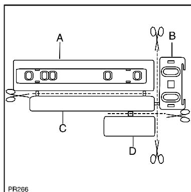
Приложите направляющую (A) на внутреннюю сторону двери шкафа, сверху и снизу, как показано на рисунке, и отметьте положение крайних отверстий. Подготовив отверстия, установите направляющую при помощи входящих в комплект винтов.
