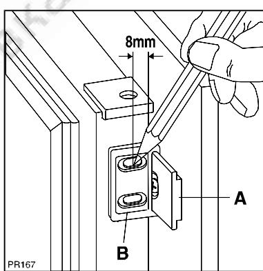
Для выравнивания двери шкафа пользуйтесь регулировочными прорезями.
