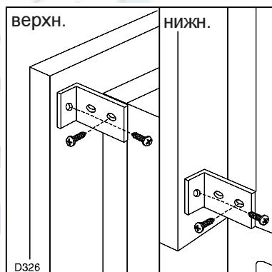
Прикрепите прибор к столешнице или к боковым панелям с помощью фиксирующих скоб (E). Затем между морозильником и прилегающими панелями мебели проложите ленту уплотнителя.
