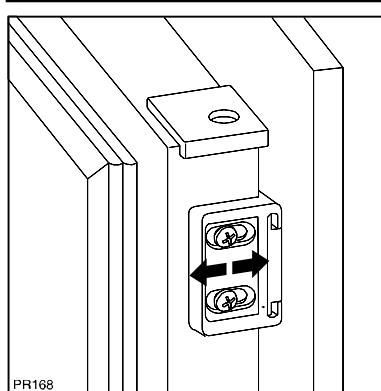
Установите и защелкните крышку (D) на направляющей (B).
