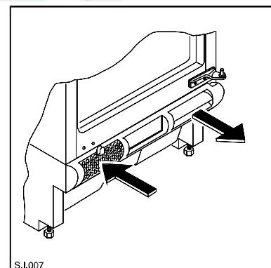
Если высота монтажного проема составляет  $A=820$  мм, а высота плинтуса  $a=100$  мм, плинтус может быть установлен без дополнительных настроек. Также дополнительные настройки не требуются, если высота монтажного проема  $B=870$  мм, а высота плинтуса  $b=150$  мм.
